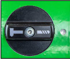
Symbol Bohrer auf Markierung - Bohren ohne Softschlag
